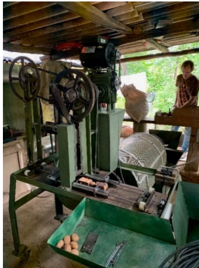
Figura 5 – Máquina desenvolvida pelo agroextrativista João para a mecanização da quebra do fruto do baru na comunidade do Rio Bonito em Cavalcante (GO). Imagem de Júlio Itacaramby.
